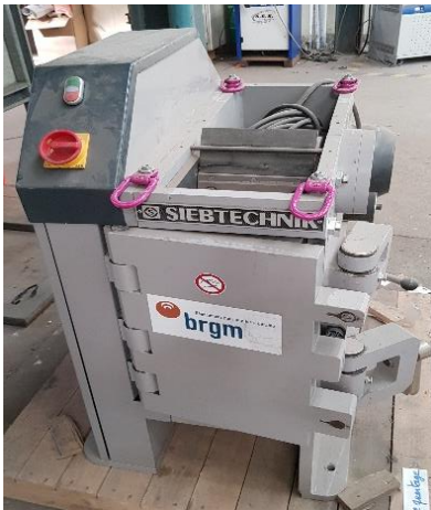
Figure 4. Jaw crusher Siebtechnik (@BRGM)
