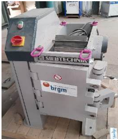
Figure 4. Jaw crusher Siebtechnik (@BRGM)
